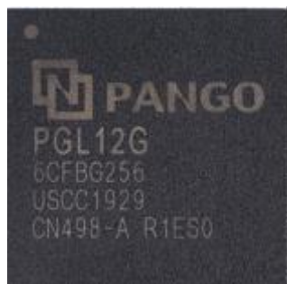
图 2-2-1 FPGA 芯片实物
