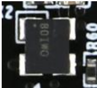
图 2-3-2 50M 有源晶振实物图
